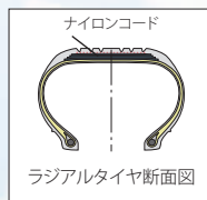
最新ラジアル構造(RRR)断面図
