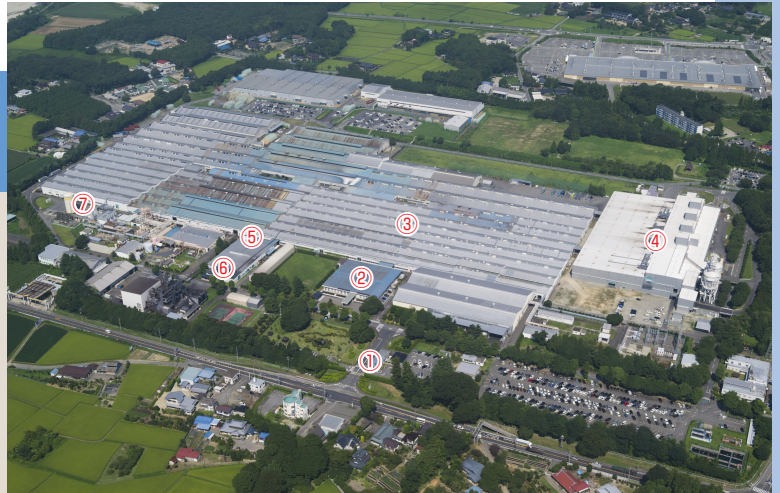
①正門 ②事務所 ③主工場 ④バンパリー棟 ⑤保全センター ⑥試験センター ⑦コ・ジェネレーションシステム
