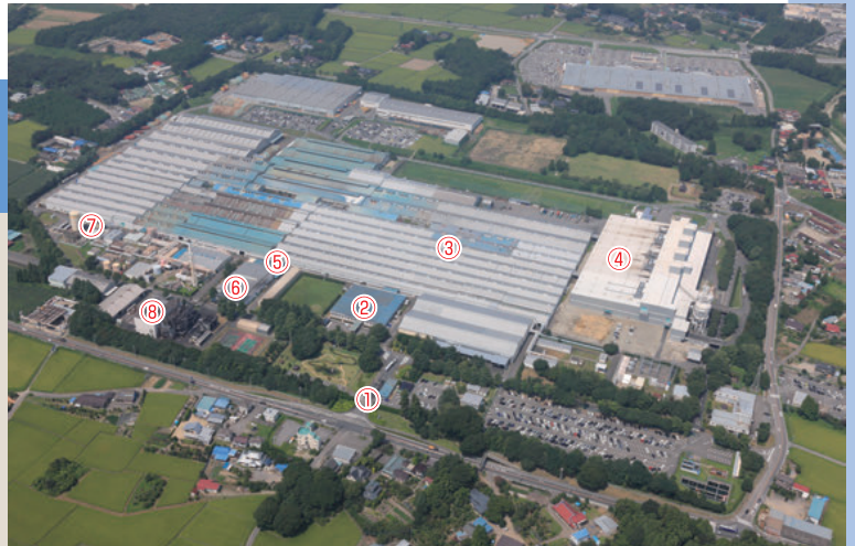
①正門 ②事務所 ③主工場 ④バンパリー棟 ⑤保全センター ⑥試験センター ⑦コ・ジェネレーションシステム ⑧使用済みタイヤ焼却発電設備
