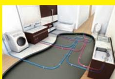
水を通すパイプと、部品同士をつなげる継手からできている給水・給湯配管システム
