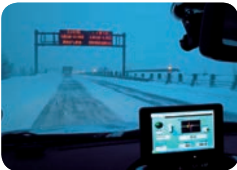
「CAIS」を用いて路面状態を判別している様子
