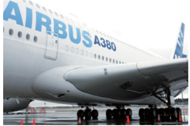
航空機用タイヤは、その寿命において通常3~6回路面に接するゴム部分の張り替え(リトレッド)を行い、リユースすることで廃棄にかかるCO 2 を大幅に削減する
